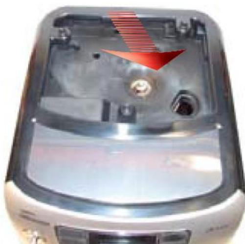
Então Remover a "Tampa" da máquina indicada na figura abaixo como a peça "10". Levantando a parte de trás para cima e puxando-a para trás.
